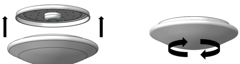
**Regelung der Farbtemperatur / adjusting color temperature**
